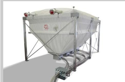
**Depositi a solco.** Offrono capacità di stoccaggio elevata in locali stretti. A seguito della loro forma possono generalmente essere riempiti fino al soffitto. L'estrazione avviene sia da una coclea che convoglia il pellet ad un punto di aspirazione o direttamente alla caldaia oppure attraverso diversi dispositivi di suzione.
