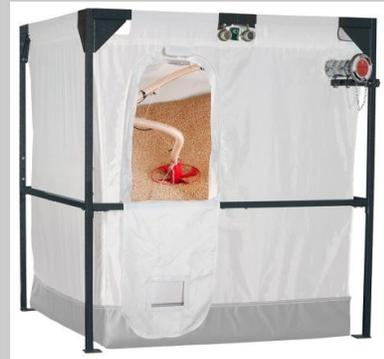
**Depositi con telaio estendibile.** Offrono un volume più piccolo se comparato con quello offerto dai depositi a fondo piatto perchè necessitano di una minore distanza fra la parte bassa del silo e il pavimento. Pertanto, il silo può piegarsi leggermente verso il pavimento - assistito da un elemento vibrante - di estrazione un buon processo di estrazione è possibile. In questo modo la quantità di pellet residuo può essere ridotta.
